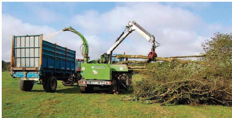
Exemple de chantier déchiquetage du bois en plaquettes
